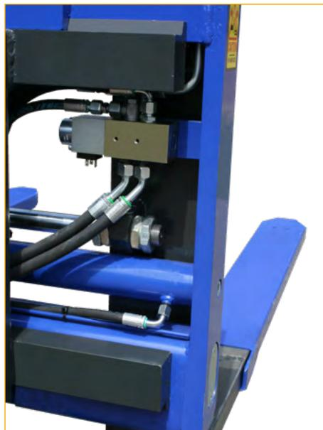
Magnetventil geschützt im Rahmen montiert.
