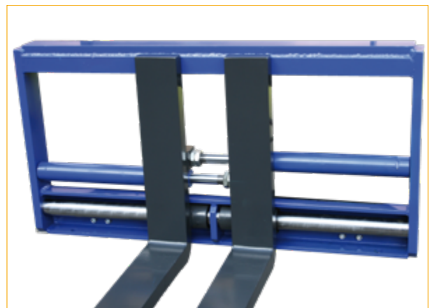
Gabelzinken in geschlossener Position.
