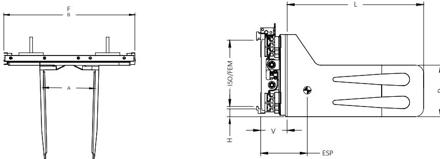
**Ballenklammer** (2 Funktionen, mit integriertem Seitenschub)
